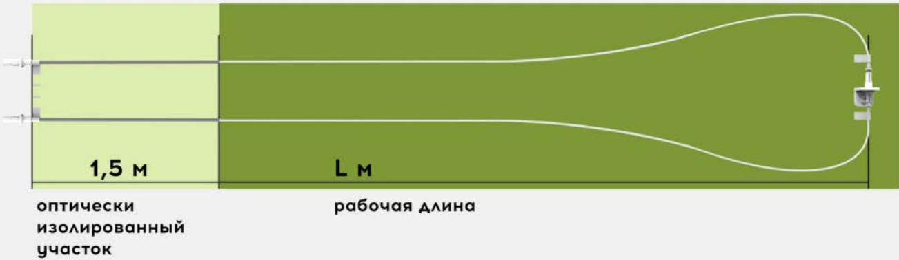
Общий вид датчика типа ТЕКИЛА
