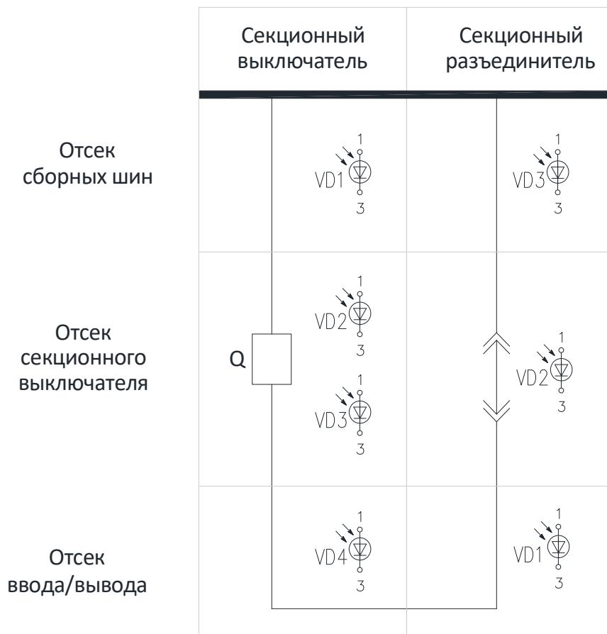
Рисунок 3.3 – Размещение датчиков ДДЗ-01 в ячейке СР
