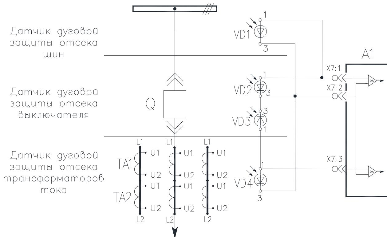
Рисунок 3.4 – Подключение датчиков ДДЗ к БЗП - 02 для ячеек вводного и секционного выключателя
