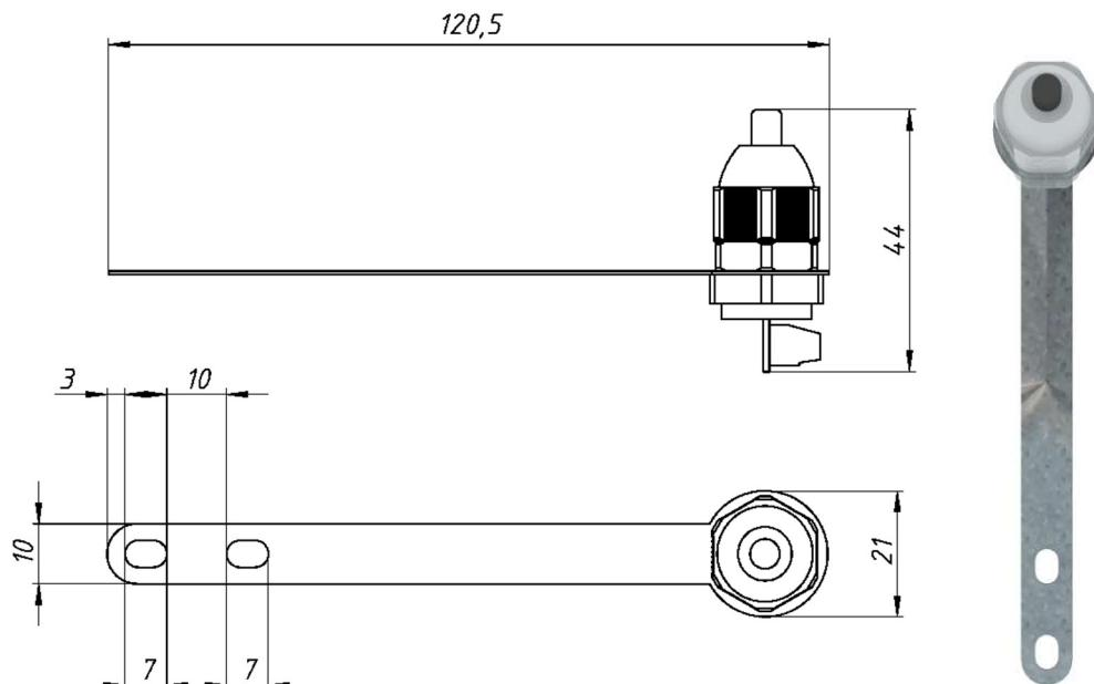
Рисунок 2.1 – Габаритные размеры датчика дуговой защиты
