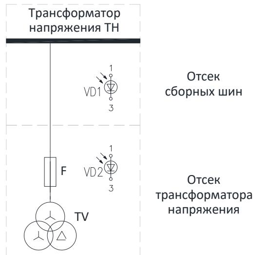
Рисунок 3.2 – Размещение датчиков ДДЗ-01 в ячейке ТН
