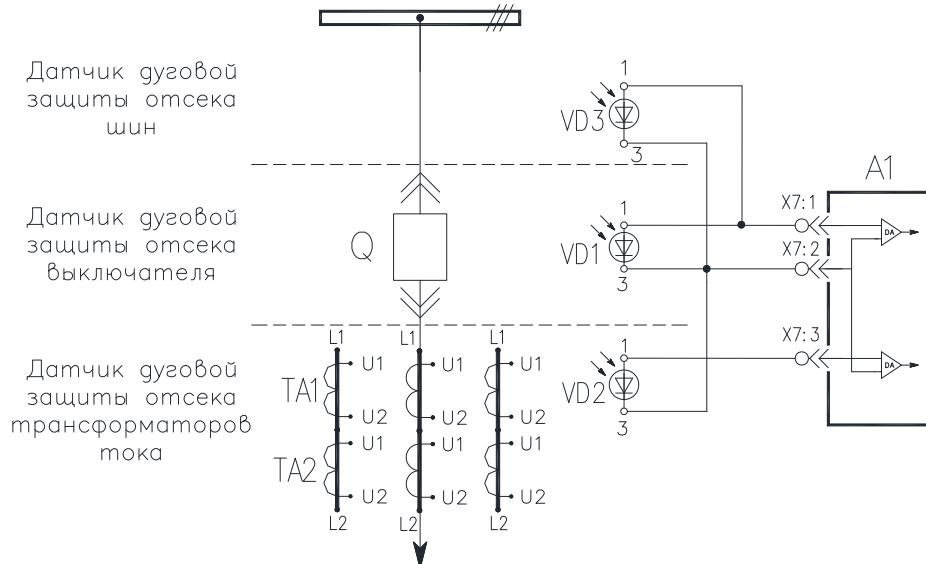
Рисунок 3.1 – Подключение трех датчиков ДДЗ к блоку Б3П-02 для отходящей линии
